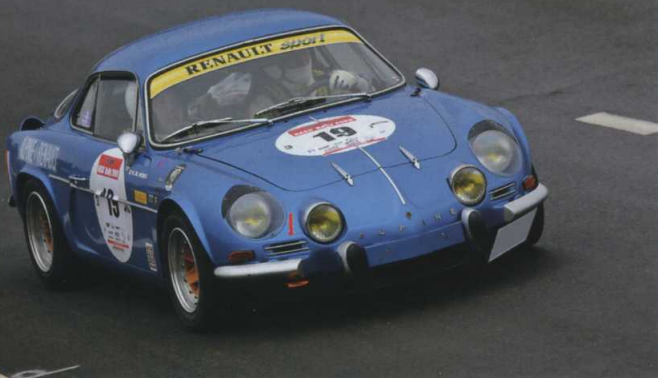
ブルーバードと双瞳をなすラリーカーが、ターマックラリーで活躍したアルビーヌ・ルノーA110で、1.6ℓのOHVエンジンをリヤに搭載する。堀、吉川選手のヘルメットが大きく見えるほど車体は小さい。
